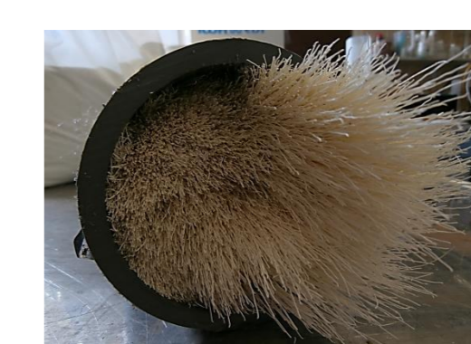
Modul s dutými vlákny firmy Air Product PA1010-P3-2A-D0 s Prism® Nitrogen Membrane
